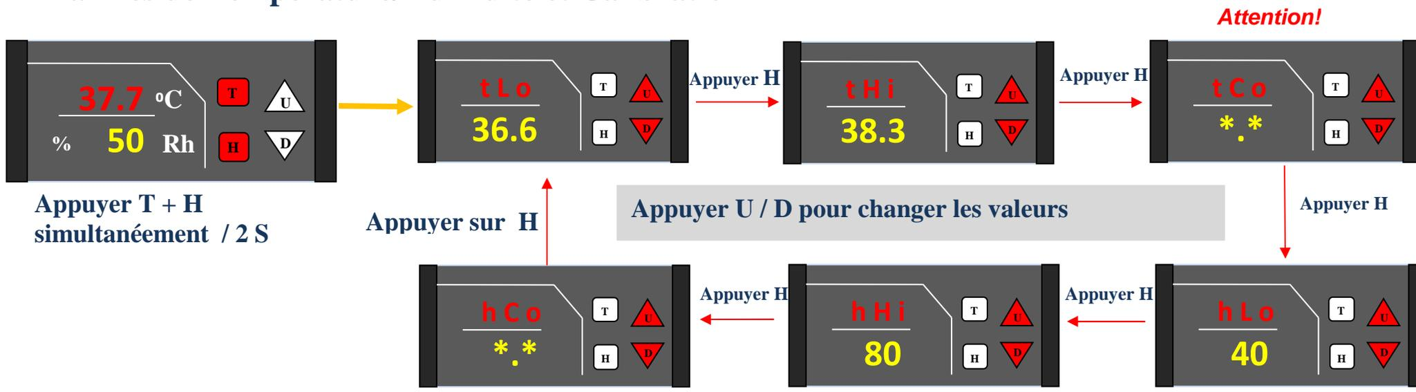
**tLo** – low temperature alarm / Une valeur plus basse déclenchera une alarme
